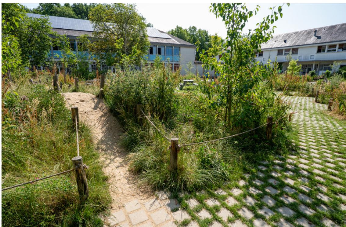
Désimperméabilisation d'une cour d'école à Tours, avec création d'espaces en pleine terre. © Gilles Lecuir
