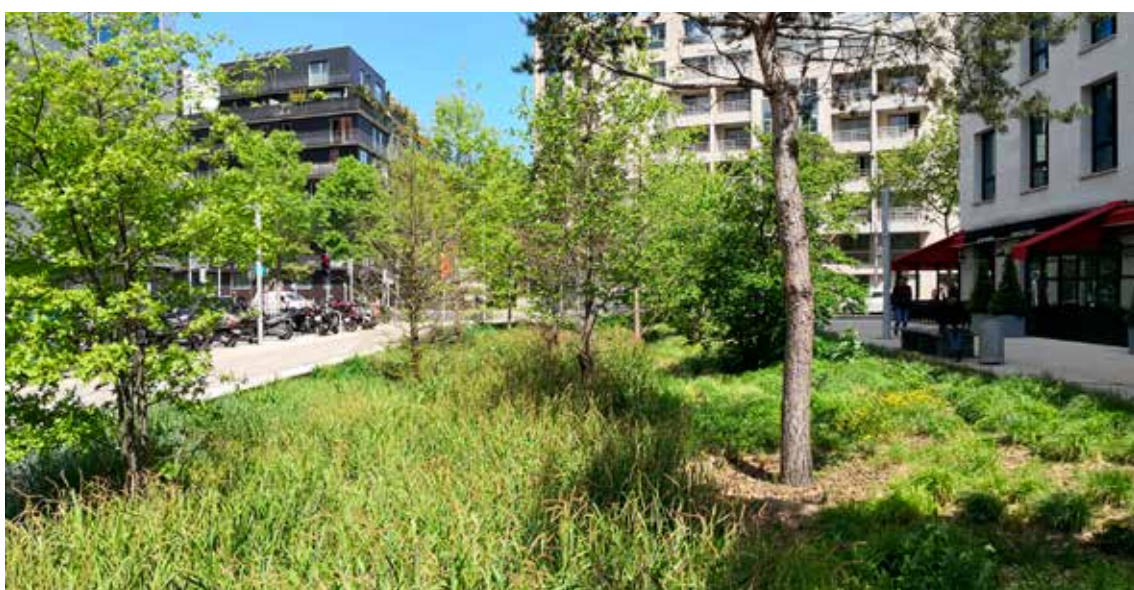
Les mares, noues végétalisées, bassins d'orage et jardins de pluie permettent de gérer les eaux pluviales et de créer une trame bleue au sein des opérations d'aménagement. © Jonathan Flandin, Gilles Lecuir, Marc Barra, Wikimedia Commons
