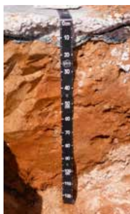
Le diagnostic pédologique est essentiel pour connaître la qualité des sols avant l'aménagement - Réalisation des fosses et description des profils de sol aux Mureaux dans le cadre du projet de recherche Destisol. © ADEME, Marc Barra
