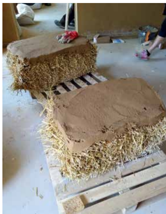
Bottes de paille porteuse pour la construction de l'école des Boutours à Rosny-sous-Bois (93). © Ville de Rosny-sous-Bois
