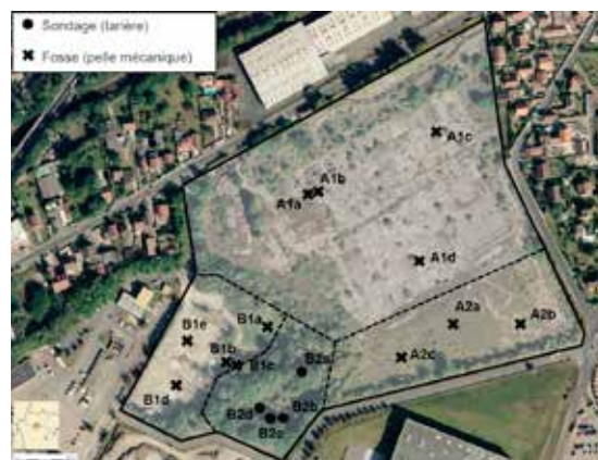
Le diagnostic pédologique est essentiel pour connaître la qualité des sols avant l'aménagement - Réalisation des fosses et description des profils de sol aux Mureaux dans le cadre du projet de recherche Destisol. © ADEME, Marc Barra
