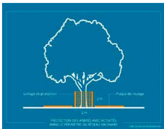
La protection des arbres nécessite un périmètre élargi (équivalent au périmètre du houppier) afin de préserver le réseau racinaire. © Brussels Environnement
