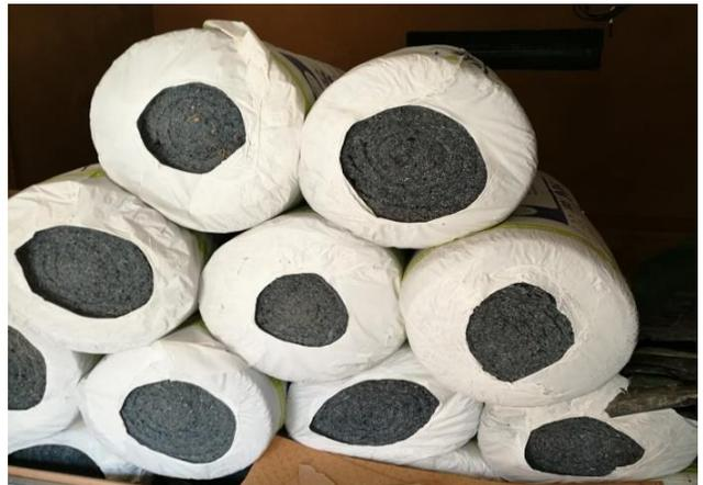
Figure 20. Isolation grâce à des jeans recyclés (Ecole des Boutours 2).. ©MarcBarra
