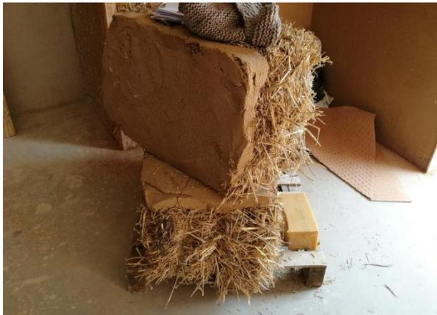
Figure 18. Bottes de paille porteuses utilisées pour la construction de l'école des Boutours 2 ©MarcBarra
