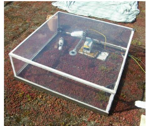
Figure 32 : Matériel utilisé par David Ramier pour mesurer l'évapotranspiration sur les toitures, les mesures sont réalisées durant une journée
