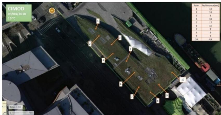
Figure 5 : Cartographie des prélèvements de substrat pour la toiture végétale de Cité de la Mode (CIMOD) sur fond de carte Géoportail au 1/333ème reprenant les épaisseurs de substrat aux différents points de prélèvement, la date de prélèvements et la température de l'air © Adeline Decourcelle
