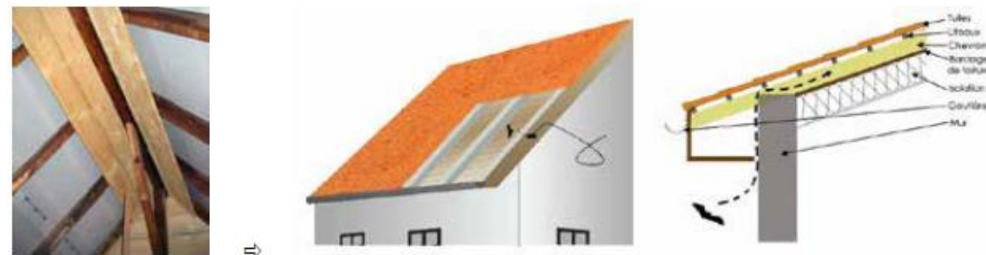
Il est possible d'intégrer des gîtes à chauves-souris dans des constructions neuves, sans compromettre l'enveloppe thermique. Source : CEREMA
