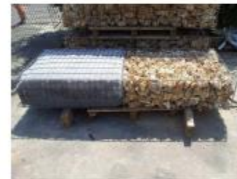
Gabions remplis de fibres de Xylit (à gauche) et de pierre dite de meulière (à droite)
