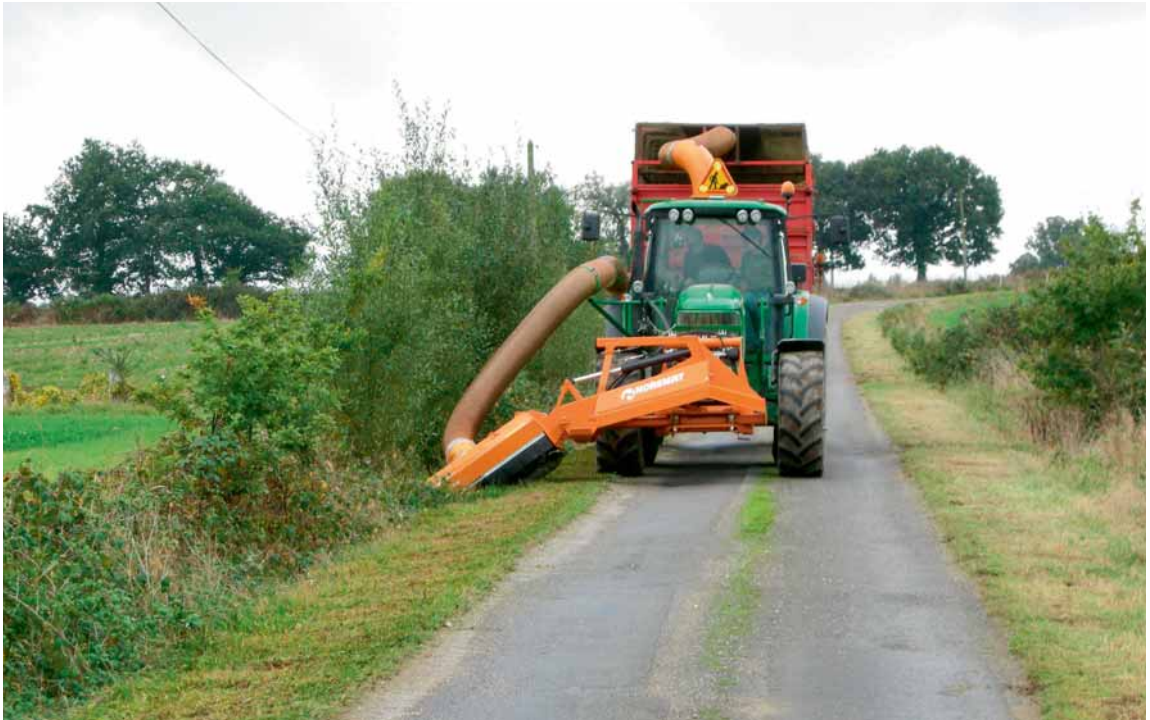
Expérimentation du frontal sur une route communale en 2010 : le fauchage avec exportation des bords de routes utilise un des engins créés pour l'expérimentation.
