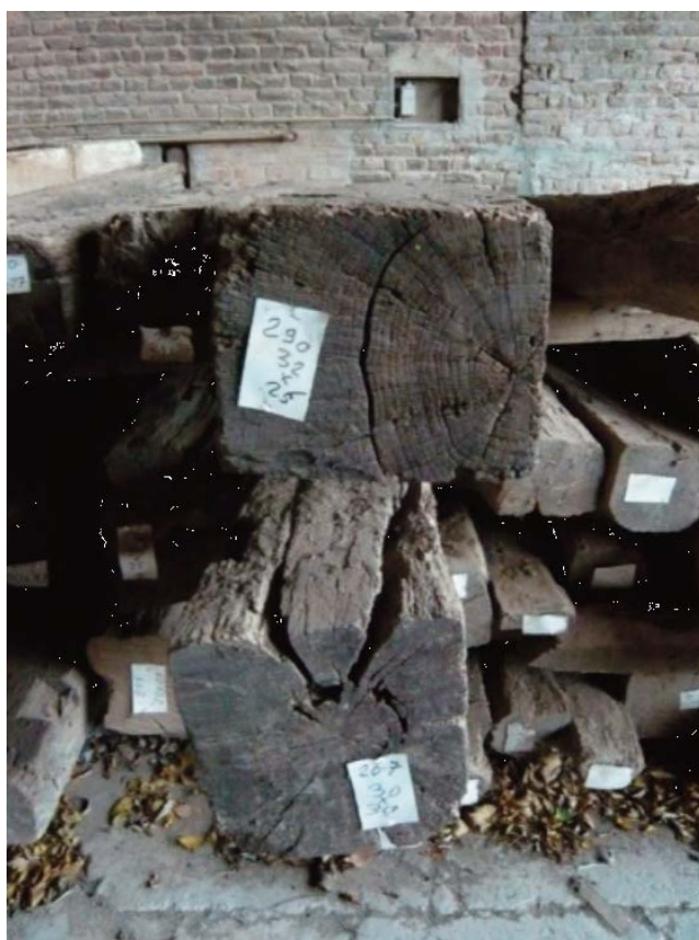
Récupération et stockage de poutres de bois dimensionnées dans le cadre d'opérations de déconstruction en Belgique. Ces poutres, comme certains tubes PVC, seront réemployées dans le cadre de nouveaux chantiers.
